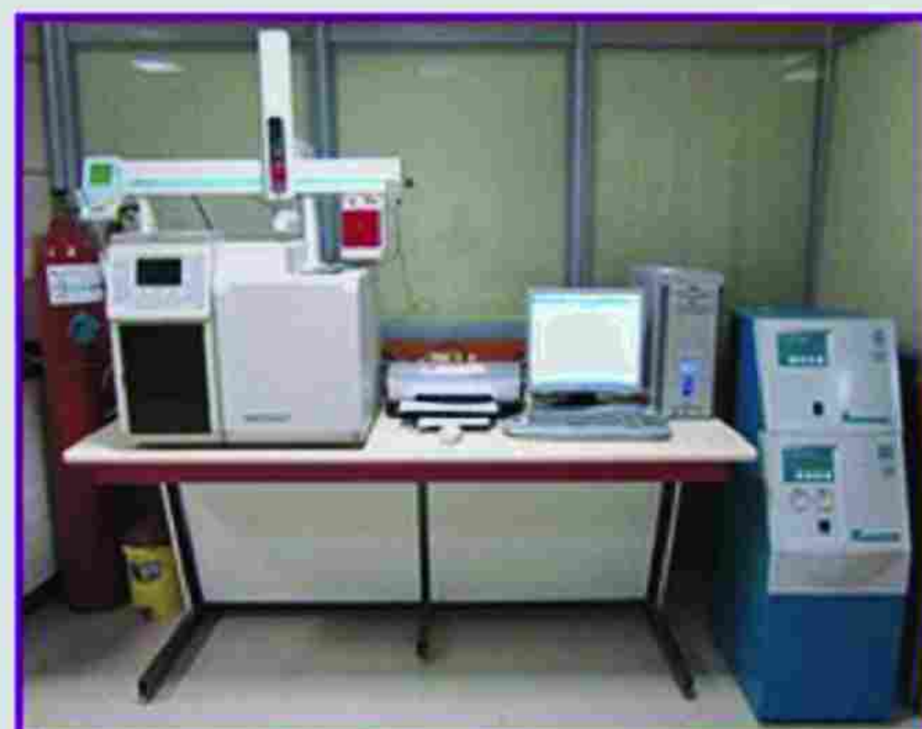
دستگاه کروماتوگرافی (GC) مدل: CP-۳۸۰۰
