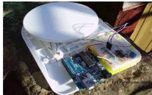
شکل ۶: تنظیمات آزمایشگاهی واسنجی یک لودسل
