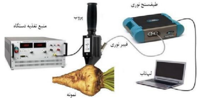
شکل ۱. چیدمان طیف‌سنجی مورد استفاده
