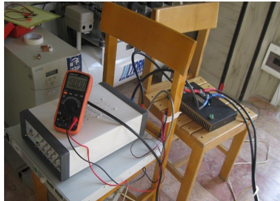
شکل ۱۰: منبع تغذیه، کنترل کننده گرمکن و دیود اضطراری کمکی
