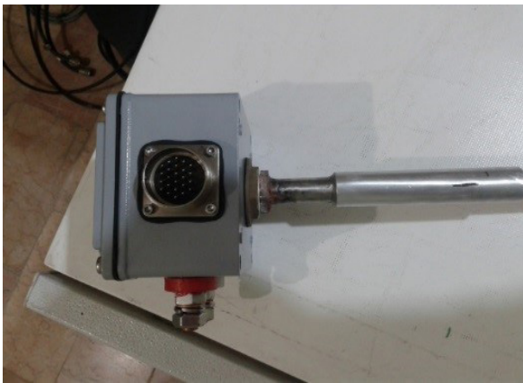
شکل ۶: شماتیکی از قسمت بالایی هدایتگر جریان ساخته شده
