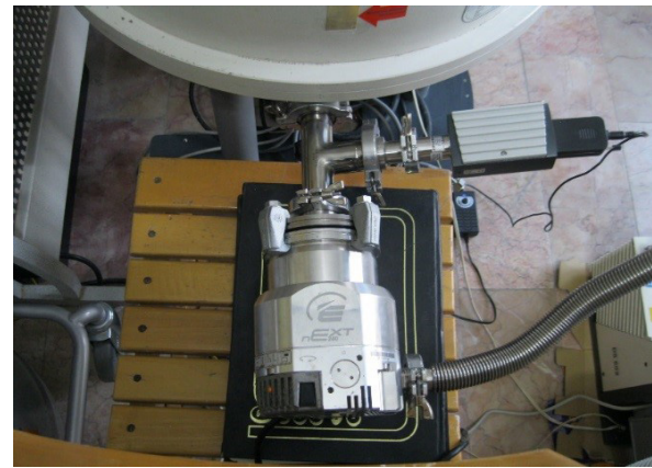
شکل ۳: اتصال پمپ توربو و فشار سنج به شیر بر خط و دستگاه به کمک سه راهی
