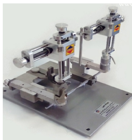
کل ۱- تصویر مربوط به دستگاه استریوتاکسی و بازوهای آن
