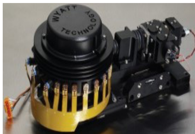
شکل ۹: نمای داخلی دتکتورها
